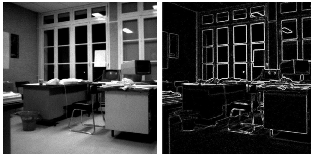
FIG. 1 – D'une image (vue de gauche), seuls les points de fort contraste (vue de droite) qui forment les contours sont utilisés.
