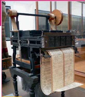
1801 La machine à cartes perforées de Jacquard
